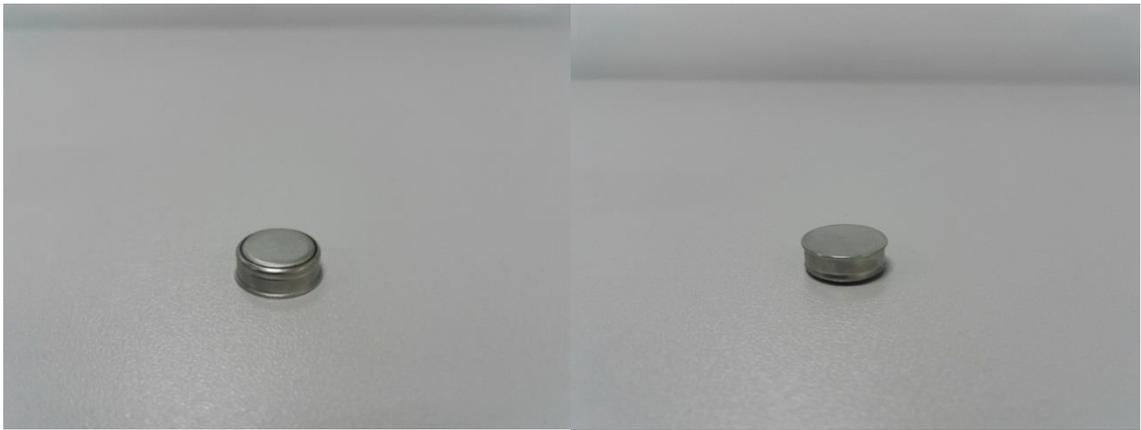
Рисунок 3 – Внешний вид термохрона «Ibutton»
